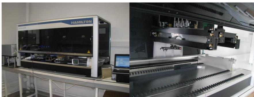
**Figure 2 : Plateforme robotisée de mesure des activités enzymatiques**
